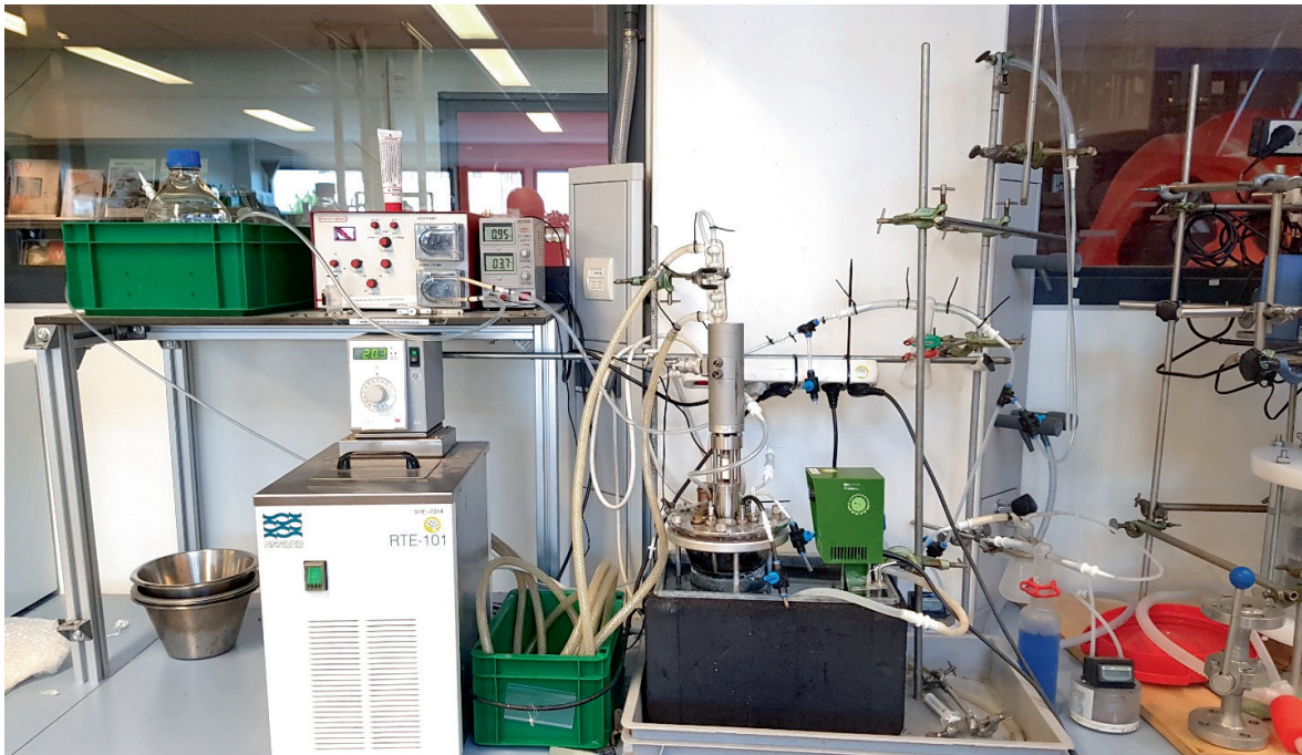
Abb 5: Der Pyrolyse Fermentationsreaktor, wie er in der Studie verwendet wurde. Der Reaktor ist temperatur- und pH-kontrolliert
