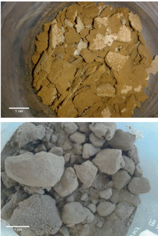
Abb. 5: Filtrat und Rückstand. Die obige Abbildung zeigt einen Ausschnitt aus getrocknetem Filtrat (links) und Rückstand (rechts). Nach dem Trocknen der Fraktionen bleibt eine harte Substanz übrig (daher die Klumpen auf dem Bild)
