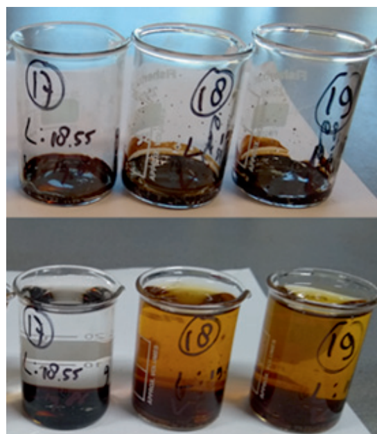
Abb. 5: Im Ofen ausgehärtete Formulierungen, vor (obere Reihe) und nach Zugabe von Wasser (untere Reihe)
