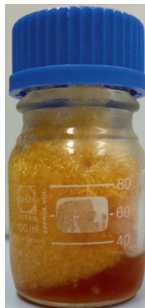
Abb. 2: Eingefrorenes wässriges Pyrolyseöl mit Eiskristallen
