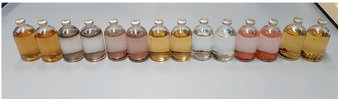
Abb. 7: Mikrobiologischer Reduktionsprozess mit Hilfe von Öl als Elektronengeber. In der oben stehenden Reihe wurden verschiedene Tests mit Schwefel und Selen Reduktion durchgeführt. Die gelbliche Färbung wird durch die Zugabe von Öl verursacht. Der rote Niederschlag zeigt deutlich die Reduktion von Selen, die festen Ausscheidungen lagern sich am Boden ab (die 3. und 4. Flasche von rechts zeigen eine klare rote Farbe auf dem Boden der Flaschen).
