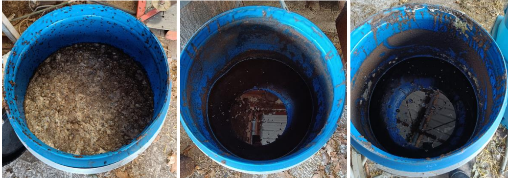
De mestvaten bij t=23 weken. Links vat A met alleen mest. Midden vat B met mierenzuur en mest. Rechts vat C met mest en azijnzuur.
