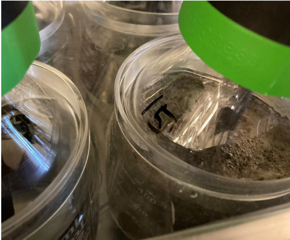
Foto 4.1: Fles 15 in de AMPTS met verse mest varkensmest met 0.04 g/g Azijnzuur
