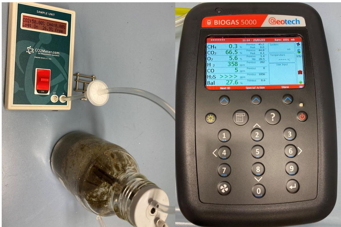
Figuur 3.1 Omschrijving van de opstelling voor gasanalyse bij mengen mest met zuur. Links CO2meter geeft meer dan 50% CO 2 en geen methaan weer. Rechts geeft een Biogas5000 analyser 66,5% CO 2 en 0,3% methaan weer. De displays op de meters geven de resultaten op t=60 minuten na het toevoegen van het zuur.
