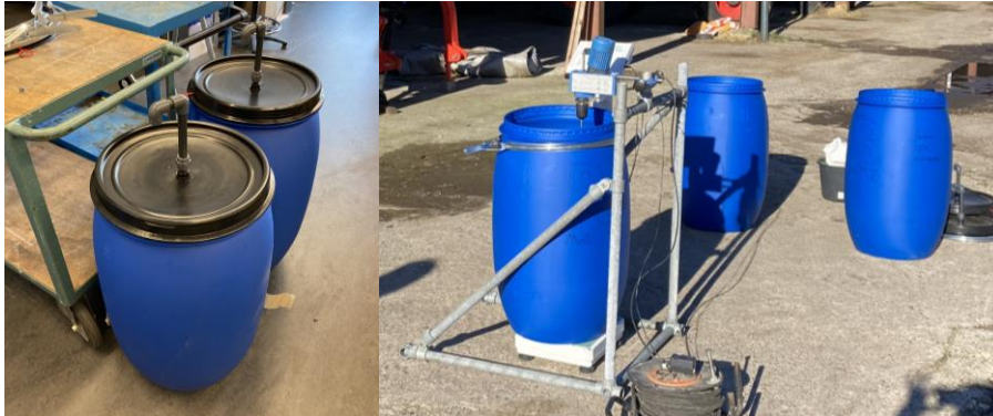
De vaten bij aanvang van het experiment, de ontluchtingspijp zit op de deksel.
