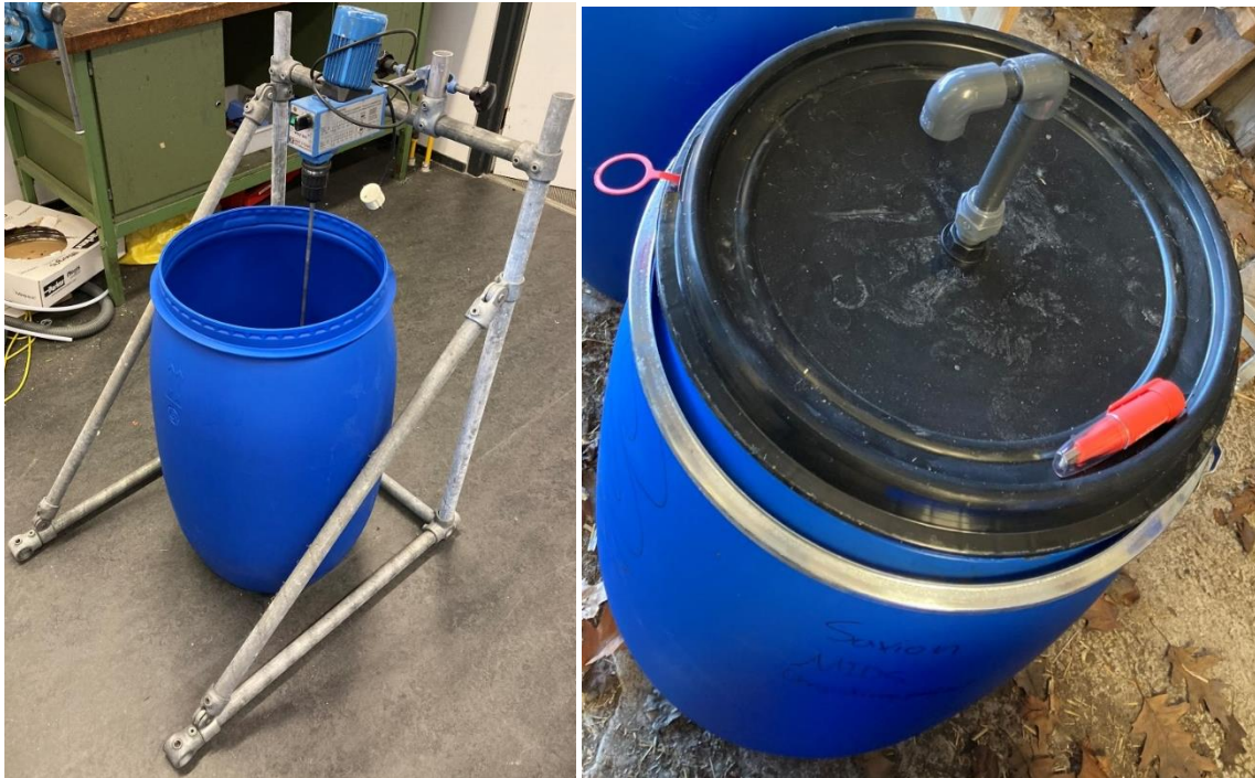
Figuur 6.2. Vat en mixer opstelling voor het mengen van mest en zuur op locatie. Het mixen is zonder deksel uitgevoerd. De deksel heeft een ontluuchtingsbuis om gasophoping te voorkomen. Op de deksel ligt een temperatuurlogger om de temperatuur te loggen. De vaten stonden in een kapschuur op het terrein van de boerderij.
