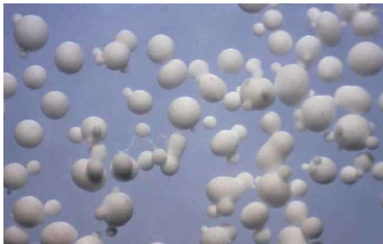
Figuur 1: Kunststof microcapsules (50x uitvergroot) gevuld met Micronal
