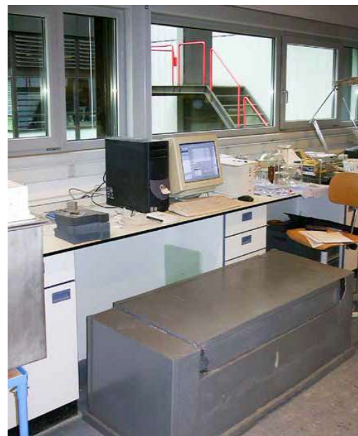
Figuur 2: Experimentele opstelling Universiteit Twente voor gebruik PCM's tijdens hydratatie van beton
