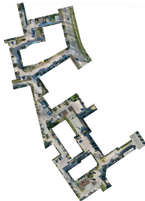
Figuur 3. Samengestelde orthofoto ('geometrisch correcte foto') van Griffiersveld gemaakt door een drone.
