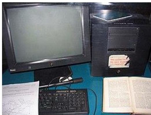
Afbeelding 106: Het World Wide Web draaide op deze eerste NEXTcube webserver uit 1990 (CERN, z.d.).
